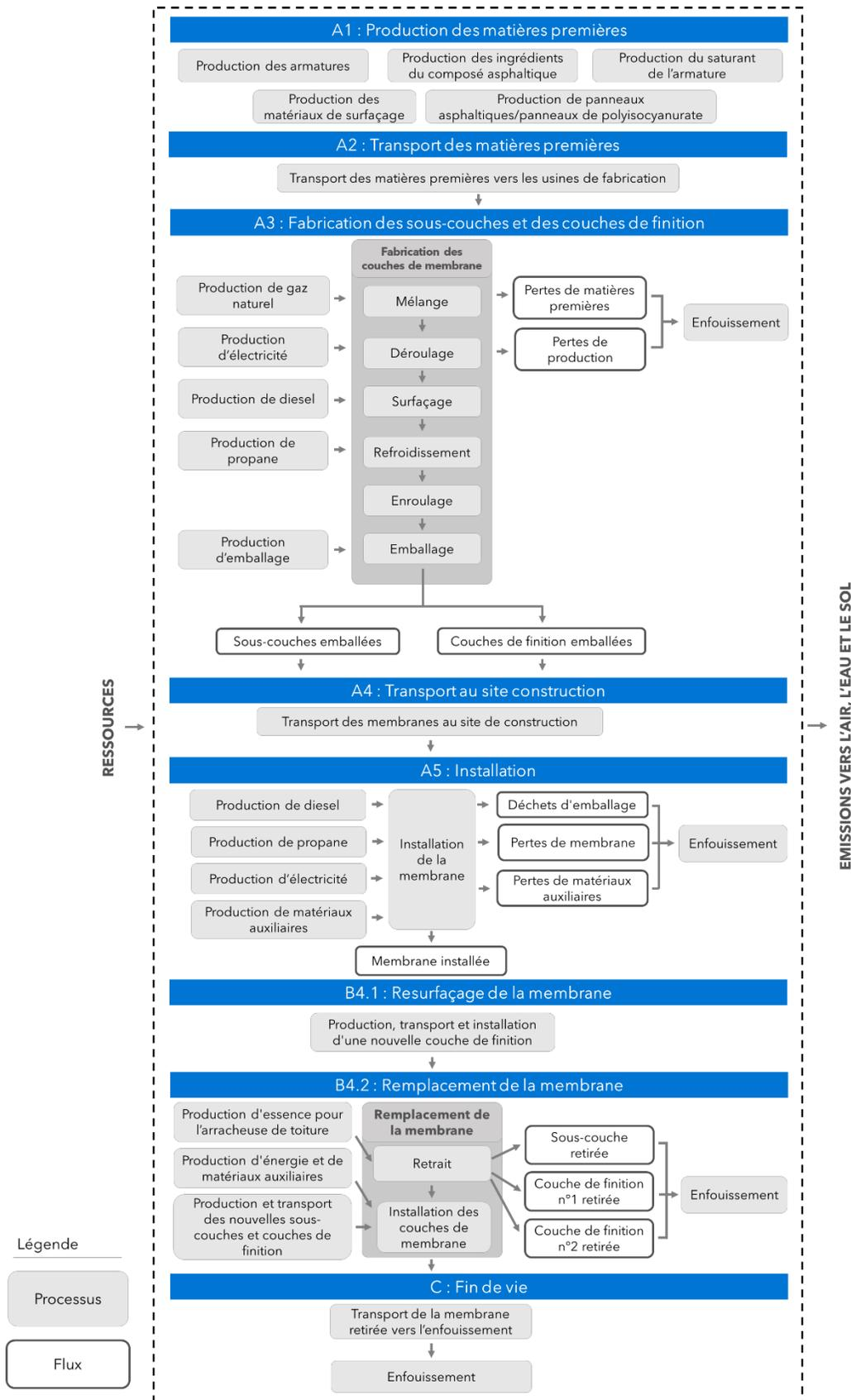
Figure 6 : Frontières du système - Membranes de bitume modifié au polymère SBS en panneaux
