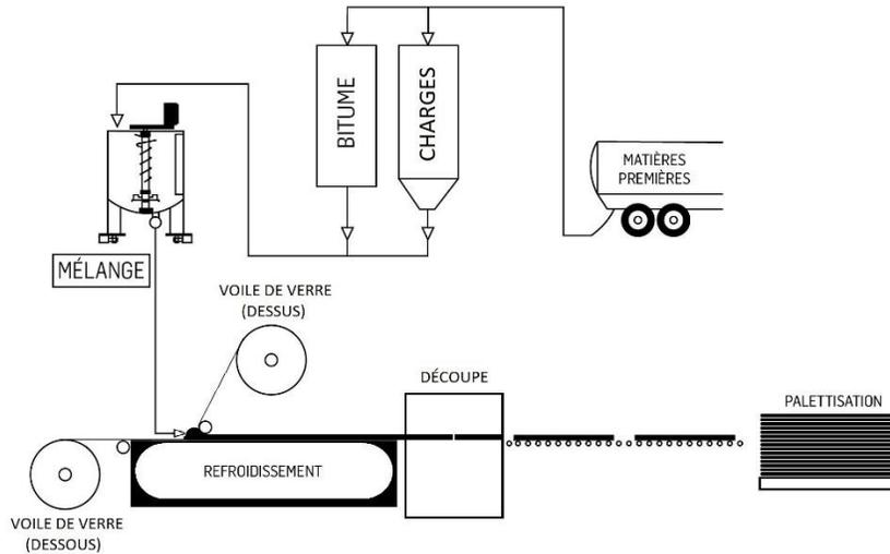
Figure 3: Étapes de production du panneau asphaltique pour les sous-couches P-A à l'usine de SOPREMA
