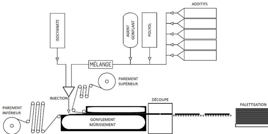
Figure 4: Étapes de production du panneau de polyisocyanurate pour les sous-couches P-P à l'usine de SOPREMA
