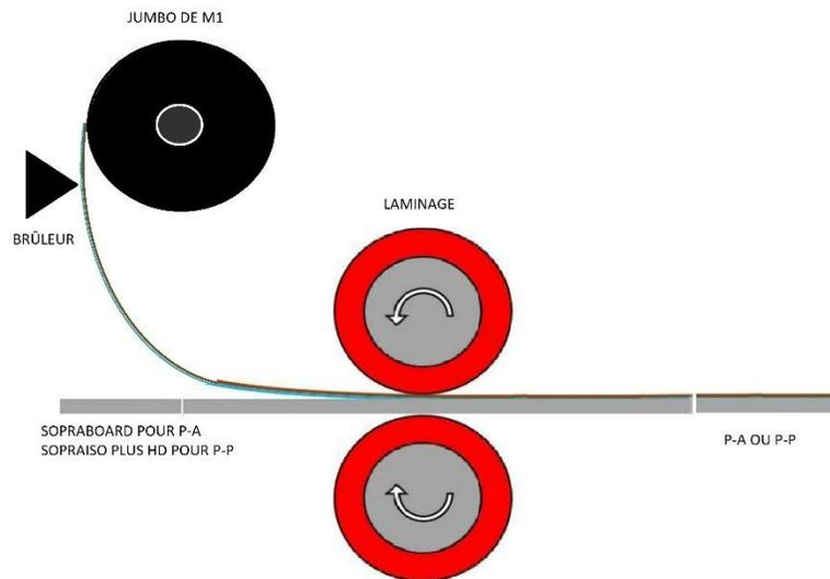
Figure 5: Lamination des sous-couches de bitume modifié SBS en panneaux à l'usine de SOPREMA
