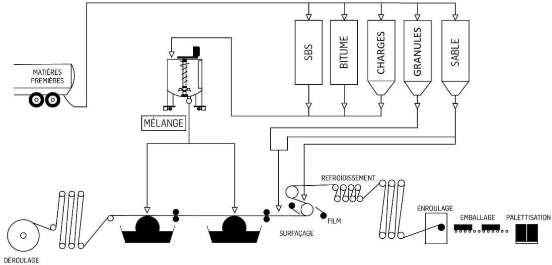
Figure 2: Étapes de production de la couche de finition de bitume modifié au polymère SBS à l'usine de SOPREMA
